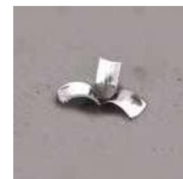
Rivet aveugle qui s'ouvre en 3 parties lors de la pose. Il est particulièrement adapté à la pose de glissières dans les matériaux composites. La tête du mandrin reste verrouillée à l'intérieur du corps du rivet après la pose ce qui confère à l'assemblage une excellente résistance au cisaillement.
