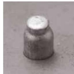
La tête du clou est retenue à l'intérieur du corps. La déformation est latérale. Pendant la pose, le corps du rivet s'expande et remplit le trou de perçage ce qui permet à l'assemblage constitué de supporter des pressions jusqu'à 35 bars.
