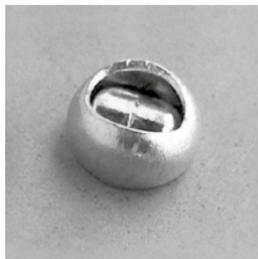
La traction sur le clou du rivet déforme le corps du rivet qui forme alors une sphère derrière les pièces à assembler.
