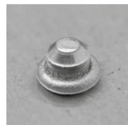
Rivet de structure qui offre un assemblage à double verrouillage (partie supérieure et partie inférieure). Le rivet se sertit en formant une large collerette côté aveugle sans endommager les pièces assemblées. Existe également en version multiserrage, acier et inox.
