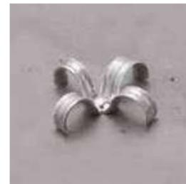
Le clou du rivet éclaté est conçu de telle manière qu'il 'découpe' le corps du rivet en 4 'pétales' qui forment un assemblage doux particulièrement adapté aux matériaux tendres ou aux fines épaisseurs à assembler.
