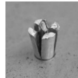
La tige est poussée à l'intérieur du rivet à l'aide d'un marteau. Le corps du rivet s'expande en 4 parties. Le rivet à frapper se pose dans de nombreux supports (bois, plastique, béton, métal...etc) ou peut être posé dans un perçage débouchant ou borgne.
