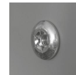
Fixation '2 pièces' utilisée pour l'assemblage de panneaux sandwich sur une structure métallique de containers ou de camions. Aucun outil spécifique n'est nécessaire pour la pose, un embout Torx TX55 suffit.
