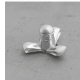
Le corps du rivet étoilé est découpé dans sa longueur en 3 parties, ce qui garantit une déformation en «3 branches» identiques. Cela préserve l'intégrité des matériaux à assembler. Ce rivet est idéal pour l'assemblage de matières plastiques.
