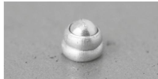
Le corps du rivet forme une double sphère après la pose. La capacité de serrage est bien supérieure à celle d'un rivet standard ce qui permet de réduire le nombre de références en stock. L'assemblage de matériaux tendres est possible grâce à la large déformation créée par le rivet.
