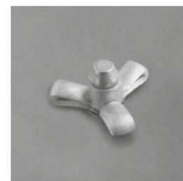
Rivet aveugle qui se déforme en trois parties lors de la pose. Particulièrement préconisé pour les matériaux tendres, grâce à sa large surface de contact qui assure une fixation optimale et une excellente résistance aux vibrations. Sa rondelle d'étanchéité pré-montée forme une barrière contre le ruissellement.
