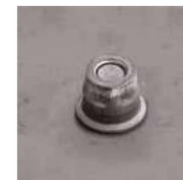
Fixation multi-serrage composée d'une tige et d'une bague. L'outil de pose sertit la bague sur le crantage de la tige. La tige casse au niveau de la bague quelque soit l'épaisseur de l'assemblage.
